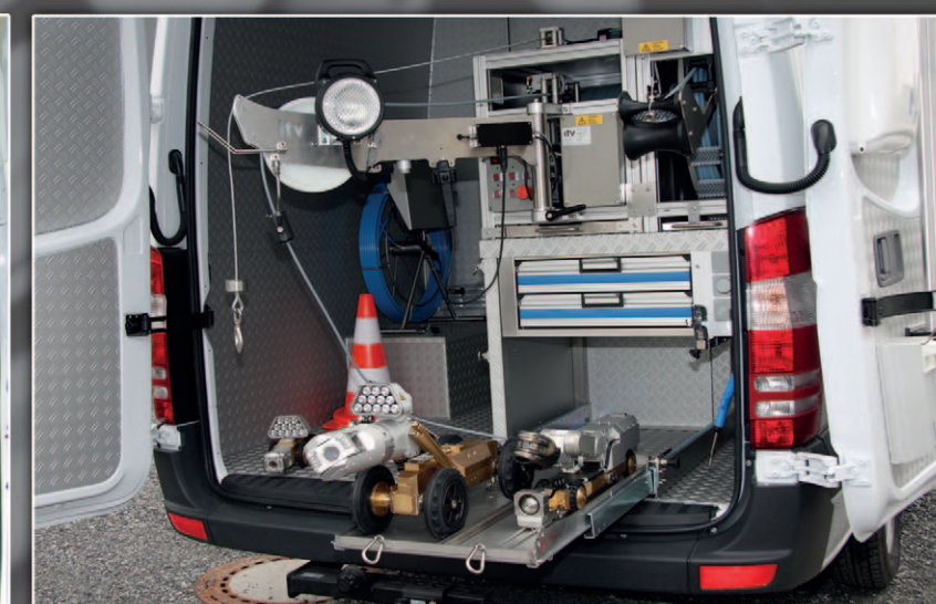
Część robocza pojazdu do inspekcji sieci TV rur – z zabudowanym systemem inspekcyjnym ITV z kamerą satelitarną – Mercedes Sprinter
