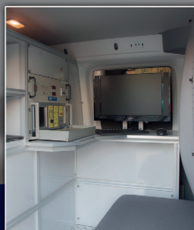
Część operatorska pojazdu do lokalizacji wycieków z zabudowanym korelatorem Fast Lokal 100/6 – VW Caddy
