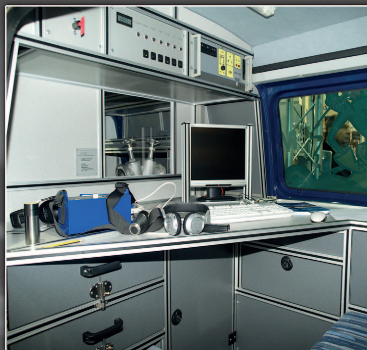
Część operatorska pojazdu do lokalizacji wycieków z zabudowanym korelatorem Fast Lokal 100/6 oraz jednostką centralną logerów szumu – VW T5
