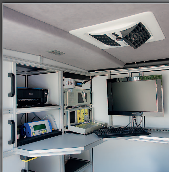
Część operatorska pojazdu do lokalizacji wycieków z zabudowanym korelatorem Fast Lokal 100/6, jednostką centralną logerów szumu, minikamerą BCS – Opel Vivaro
