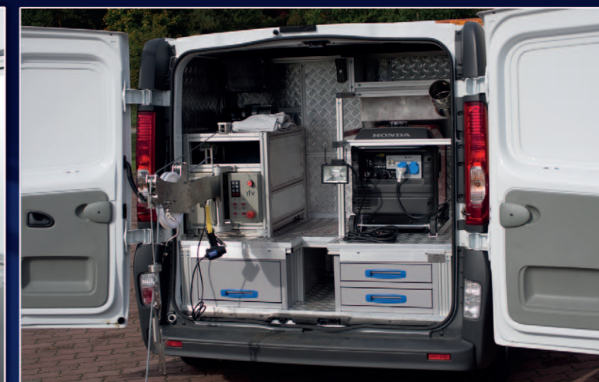
Część robocza pojazdu do inspekcji sieci TV rur – z zabudowanym systemem inspekcyjnym ITV is2, Honda EU30is – Opel Vivaro
