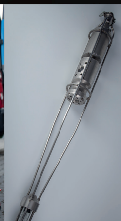
Kamera do studni głębinowych IGS HP150
