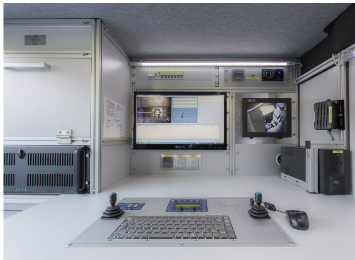
Zabudowany w furgonie DMC 3,5T, obsługiwany z poziomu sterowania systemu inspekcyjnego IGS CamBoss (obsługa zarówno wózka samojezdnego kamery jak i robota elektrycznego)
