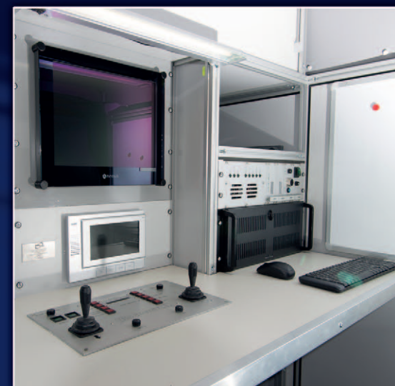
Część operatorska pojazdu do inspekcji sieci TV rur – z zabudowanym systemem inspekcyjnym IGS ProfiFlex – Ford Transit
