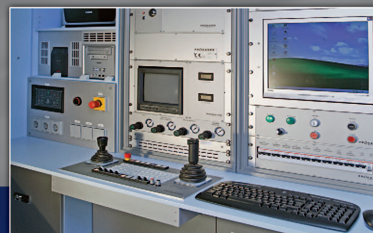
Pulpit sterowniczy pojazdu do napraw bezwypokowych z zainstalowanymi robotami – zabudowa w kontenerze
