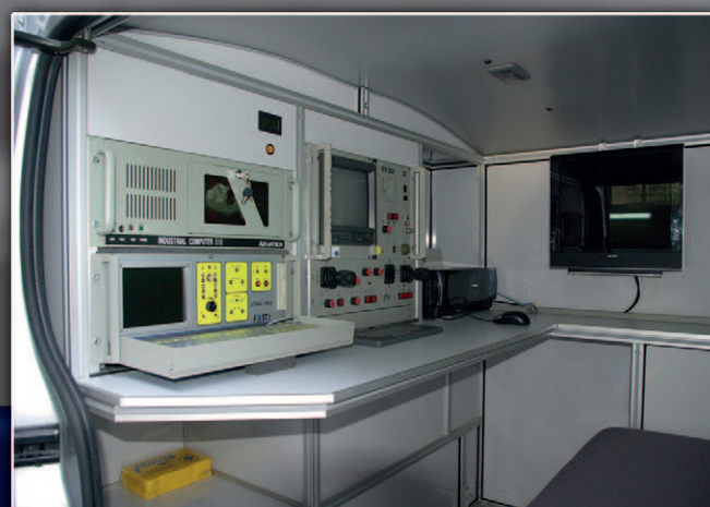
Część operatorska pojazdu do diagnostyki sieci wodociągowej i kanalizacyjnej: zabudowany korelator Fast Lokal 100/5 oraz samojezdny system ITV do inspekcji rur DN100-1500 – Opel Vivaro
