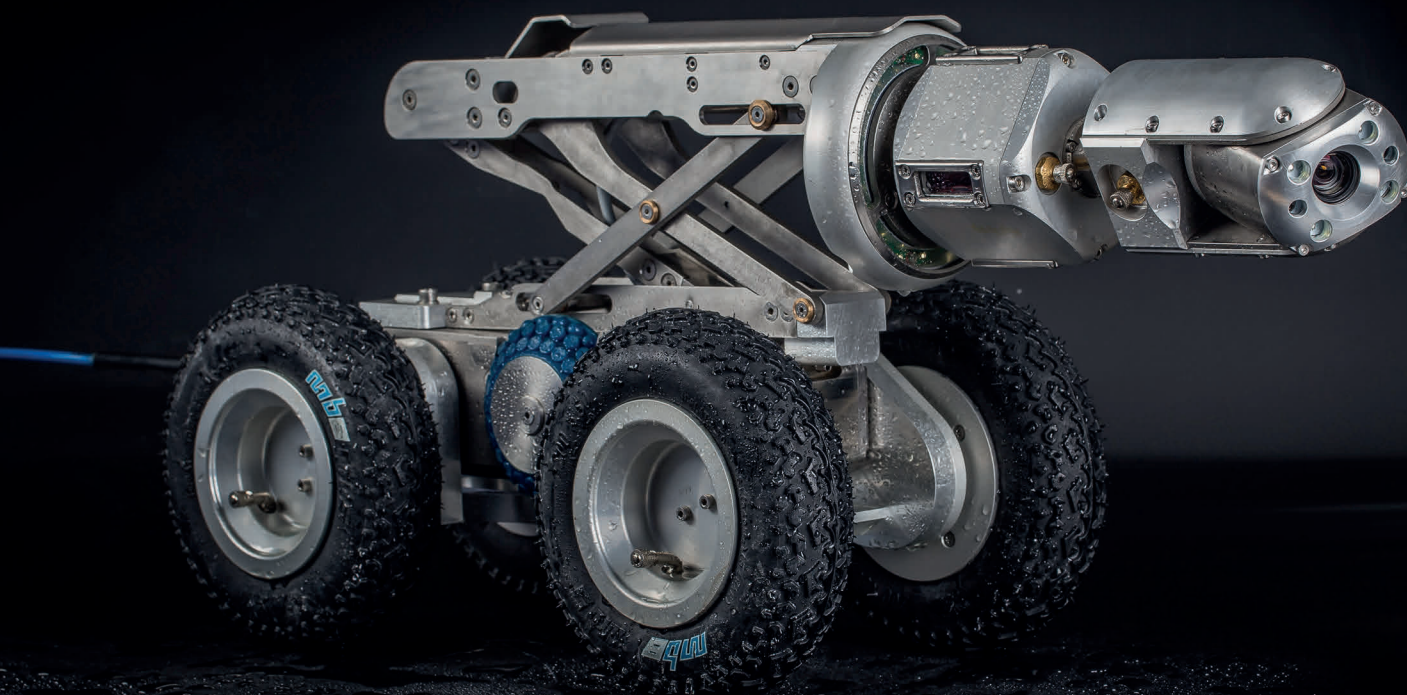
Boss150-4Ti z lawetą, pantografem, modulem do pomiaru średnic i owalności, głowica KZ90 z laserami
