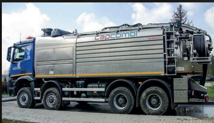
CapCombi 3200 CL FI 8x8 – zbiorniki: 8 m 3 osad, 7,1 m 3 woda; pompa ssąca HIBON: 6500 m 3 /h; pompa HD Uraca 170 bar/333 l/min., teleskopowe ramię ssawne DN 200 mm, tryb zimowy -15°C
