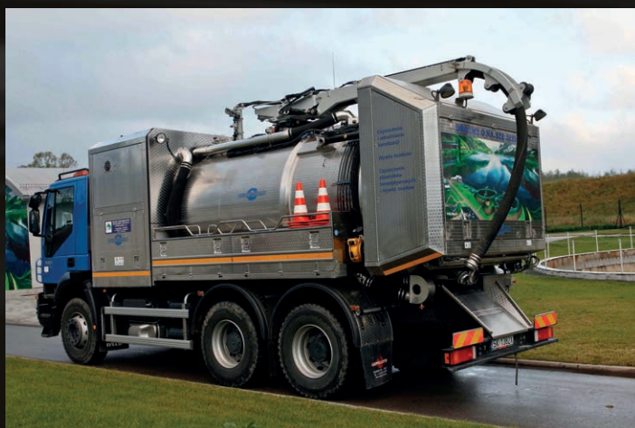
CapCombi 2600 FI – zbiorniki: 4,8 m 3 osad, 3,8 m 3 woda; pompa ssąca HIBON 1500 m 3 /h, pompa HD Uraca 200 bar/274 l/min, teleskopowe ramię ssawne, tryb zimowy: - 23°C – praca ciągła
