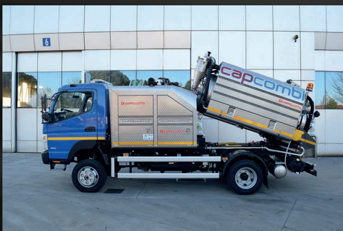
CapCombi 650 CL 4x4 / 4x2 – zbiorniki: 2 m 3 osad, 1,8 lub 1,5 m 3 woda; pompa ssąca HIBON: 1570 m 3 /h; pompa HD Uraca 160 bar/104 l/min. lub Pratissoli 150 bar/91 l/min., manualne ramię ssawne DN 100, tryb zimowy -15°C
