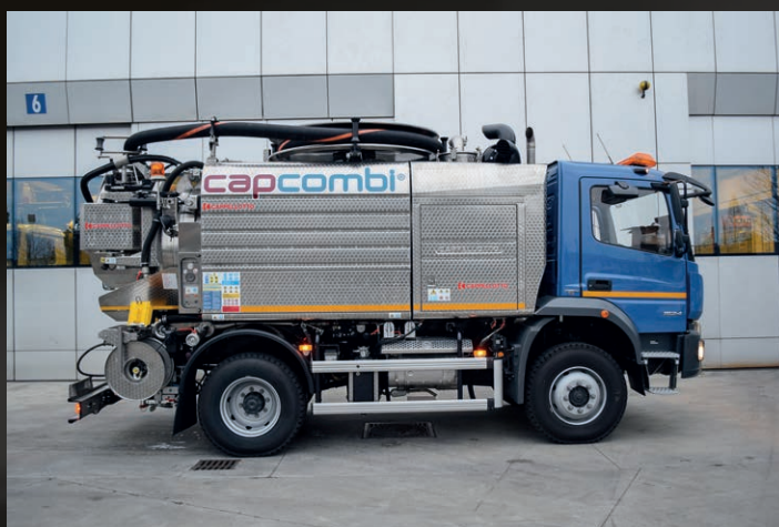
CapCombi 1600 CL 4x4 – zbiorniki: 4,4 m 3 osad, 3,0 m 3 woda; pompa ssąca HIBON: 1900 m 3 /h; pompa HD Uraca 160 bar/226 l/min.; kołowrót zintegrowany z tylnym wychylnym bębniem ciśnieniowym, tryb zimowy -15°C
