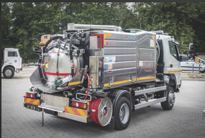
CapCombi 650 CL 4x4 / 4x2 – zbiorniki: 2 m 3 osad, 1,8 lub 1,5 m 3 woda, pompa ssąca HIBON: 1570 m 3 /h; pompa HD Uraca 160 bar/104 l/min. lub Pratissoli 150 bar/91 l/min., manualne ramię ssawne DN 100, tryb zimowy -15°C, możliwe wykonanie pojazdu o wysokości 2 m
