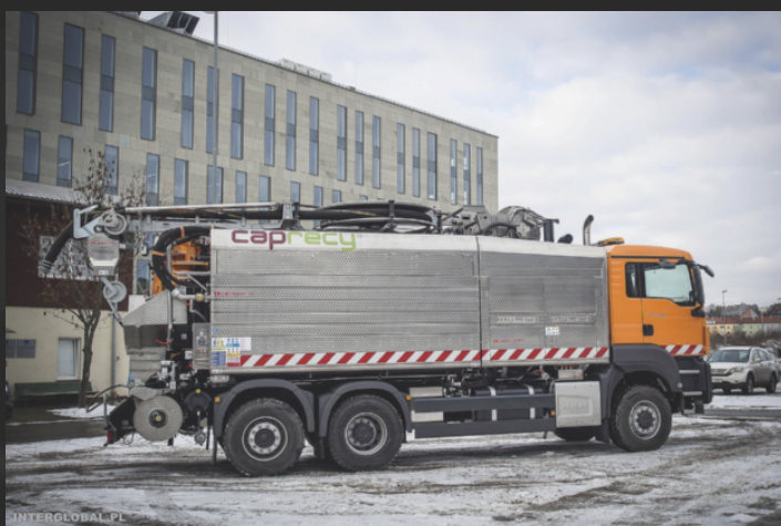
CapRecy 2600 – automatyczny system odzysku wody; zbiorniki: 8 m 3 osad, 6 m 3 woda; pompa ssąca HIBON: 2800 m 3 /h; pompa HD Uraca 205 bar/346 l/min.; kołowrót zintegrowany z wysięgnikiem teleskopowym, tryb zimowy -15°C
