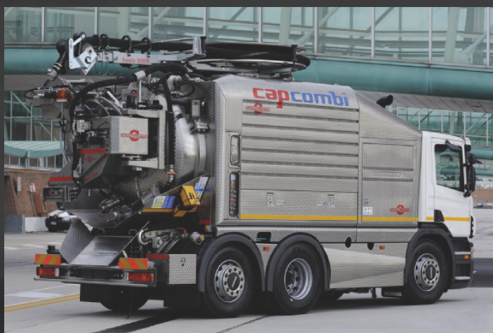
CapCombi 2600 CL FI – długość tylko 8,3 m, zbiorniki: 7,0 m 3 osad, 4,3 m 3 woda; pompa ssąca HIBON 4500 m 3 /h, pompa HD Uraca 170 bar/330 l/min; kołowrót zintegrowany z wysięgnikiem teleskopowym, tryb zimowy -15°C
