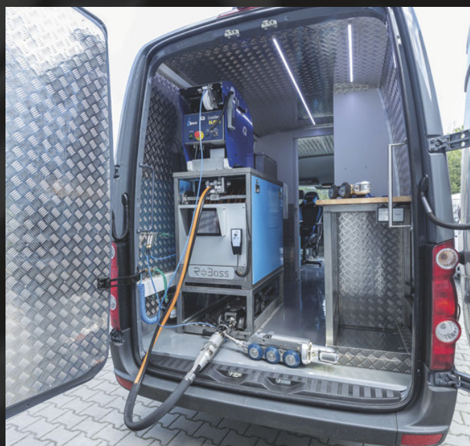
Pojazd do inspekcji TV oraz napraw bezwykopowych robotem frezującym System IGS CamBoss/ RoBoss , pojazd bazowy VW Crafter – zasilanie ogniwa akumulatorowe
