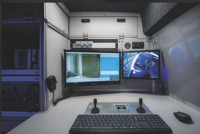
Część operatorska - system inspekcyjny IGS CamBoss DN150-1200, zabudowa w pojeździe VW T6
