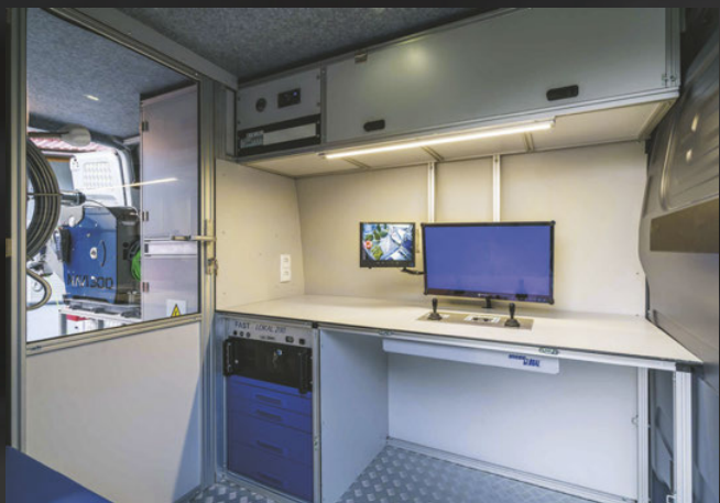
Część operatorska pojazdu do obsługi sieci wod-kan, zabudowany korelator Fast Lokal 200PC oraz system inspekcyjny IGS CamBoss, zasilanie akumulatorowe, pojazd bazowy Mercedes Sprinter
