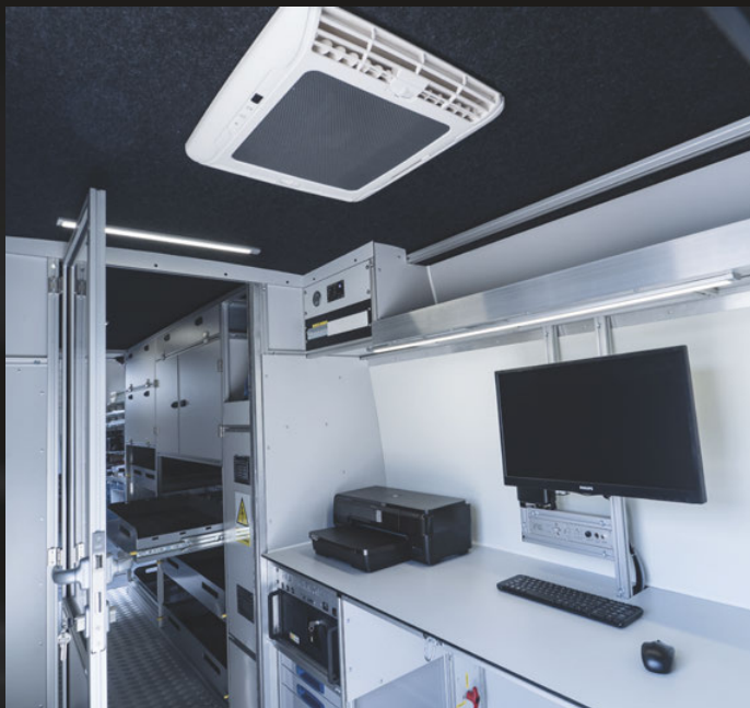
Część operatorska pojazdu do badania sieci wodociągowej, zabudowany korelator Fast Lokal 200, loggery strefowe, zasilanie akumulatorowe – Mercedes Sprinter extra długi
