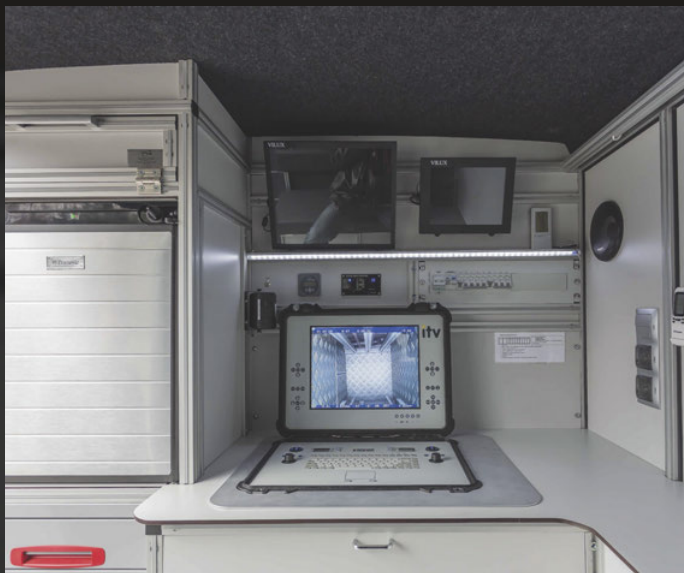
Część operatorska, system inspekcyjny ITV – sterowanie mobilne, zabudowany w pojeździe Mercedes Sprinter 4x4
