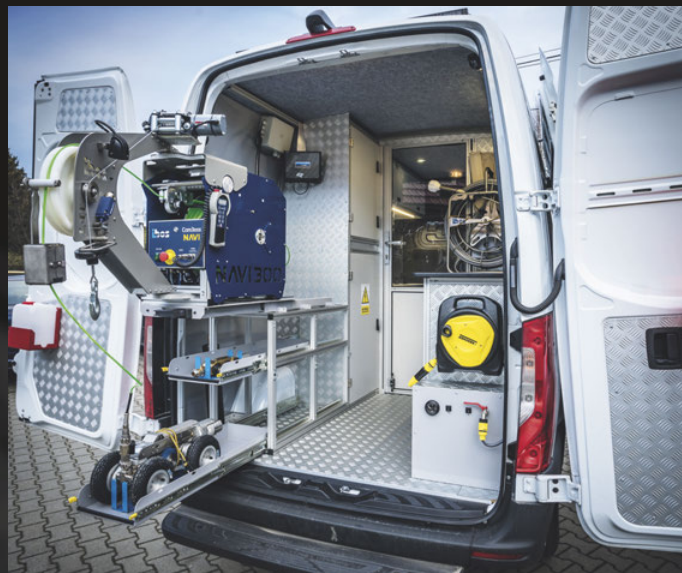
Część robocza - warsztatowa, system inspekcyjny IGS CamBoss DN100-2000, zasilanie akumulatorowe
