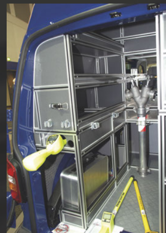
Część robocza (warsztatowa) pojazdu do lokalizacji wycieków – VW T5
