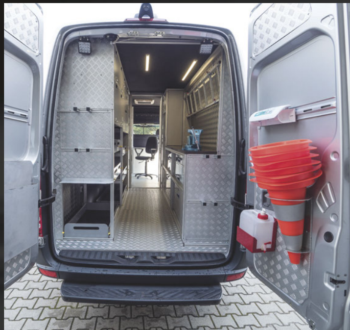
Część robocza (warsztatowa) pojazdu do badania sieci wodociągowej, Mercedes Sprinter extra długi
