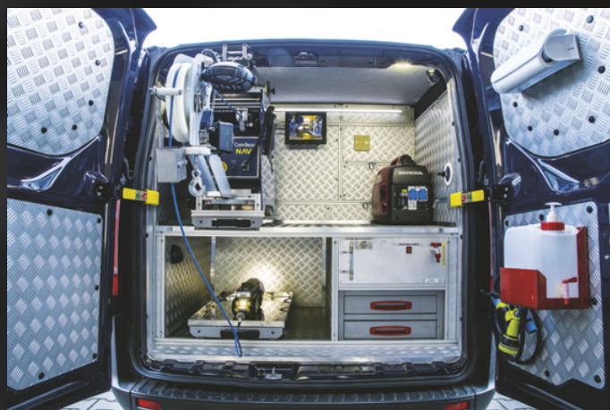
Część robocza - system inspekcyjny IGS CamBoss DN150-1200, zasilanie akumulatorowe, zabudowa w pojeździe Ford Transit Custom
