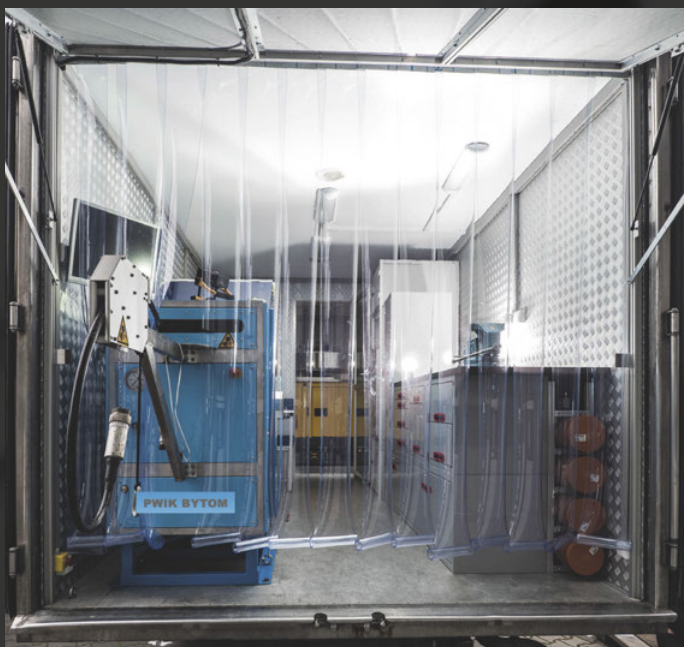
Pojazd do napraw bezwykopowych rurociągów przy zastosowaniu rękawów poliestrowych utwardzanych promieniami UV. System lamp UV, kompresor (dmuchawa), agregat 40 kVA, warsztat roboczy oraz część socjalna. Pojazd Iveco DMC 15T - zabudowa w kontenerze ze ścianą oddzielającą agregat i kompresor.
