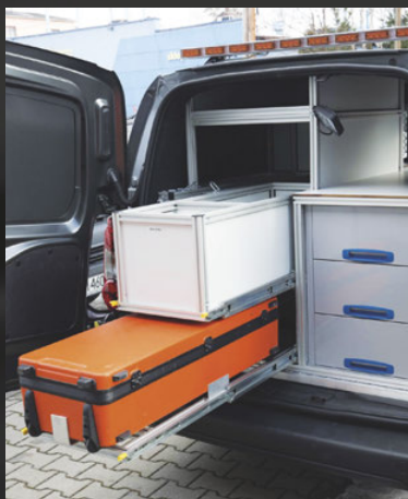
Zabudowa warsztatowa urządzeń do diagnostyki sieci wodociągowej w pojeździe Citroen Berlingo.
