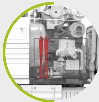
5. CYKLONY KOŃCOWE DO ELIMINACJI ZAWIESINY STAŁEJ
